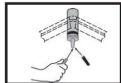
Le DS-2800 est fourni avec un tube de protection contre le débordement qui doit être installé dans le trou au fond du bac à eau. Bien qu'il soit fortement recommandé d'utiliser cet équipement, si vous ne désirez pas l'utiliser ou si vous n'avez pas de drain de plancher, laissez le capuchon en vinyl installé en usine sur l'extrémité du tube.
